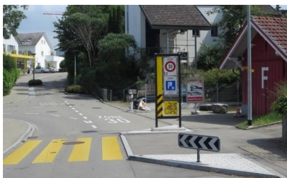
Abbildung 13: Prinzip eines Zoneneingangs als Eingangstor bei einem Fussgängerstreifen
